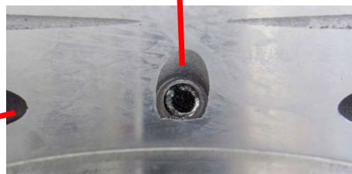
MANDATORY LINER LOCKING PIN GOUPILLE OBLIGATOIRE DE BLOCAGE DE LA CHEMISE
